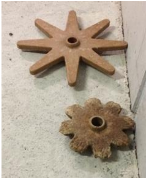
Exemple de 2 étoiles issues de la transformation de la biomasse. Objet neuf non utilisé (en haut), Le même objet en fin de période d'engraissement (en bas).
